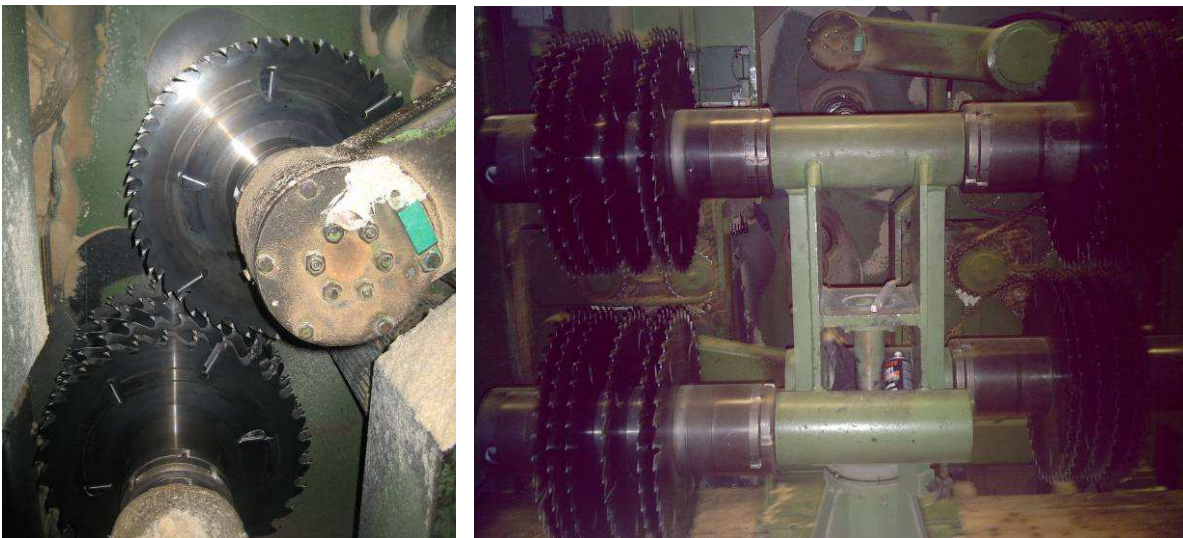
Figure II-29II-30 : Déligneuse MKV, lames montées à gauche, tourniquet de changement à droite
