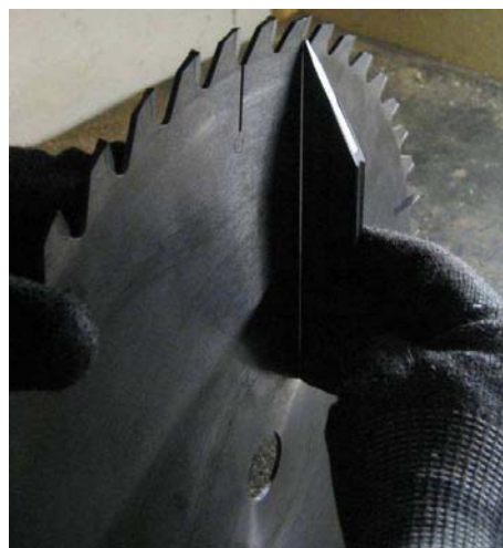
Figure IV-7 : Détection d'une bosse au réglelet
