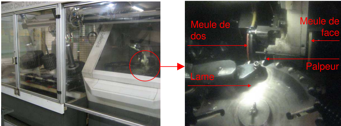
Figure IV-16 : Robot de chargement et tête d'affûtage Walter
